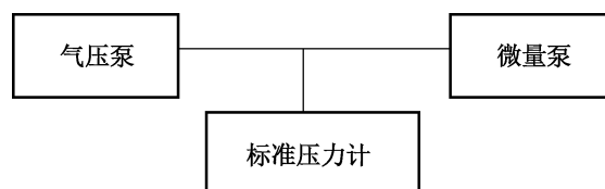
图 3 阻塞压力测量连接示意图
